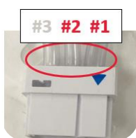
#1、#2 共に圧力検知あり=レッグスリーブ装着と判断
